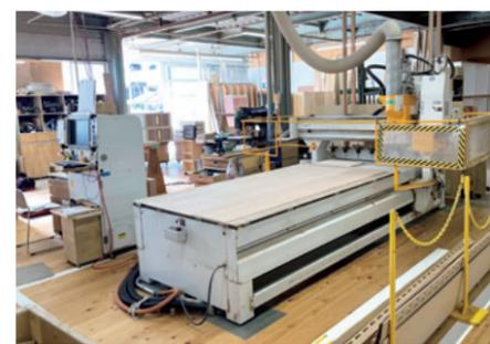
数値制御によって木材にいろいろな形状の溝や穴を開けたりする機械（NCルーター）。効率よく正確な作業を行うために、こうした大型機械を積極的に活用している
